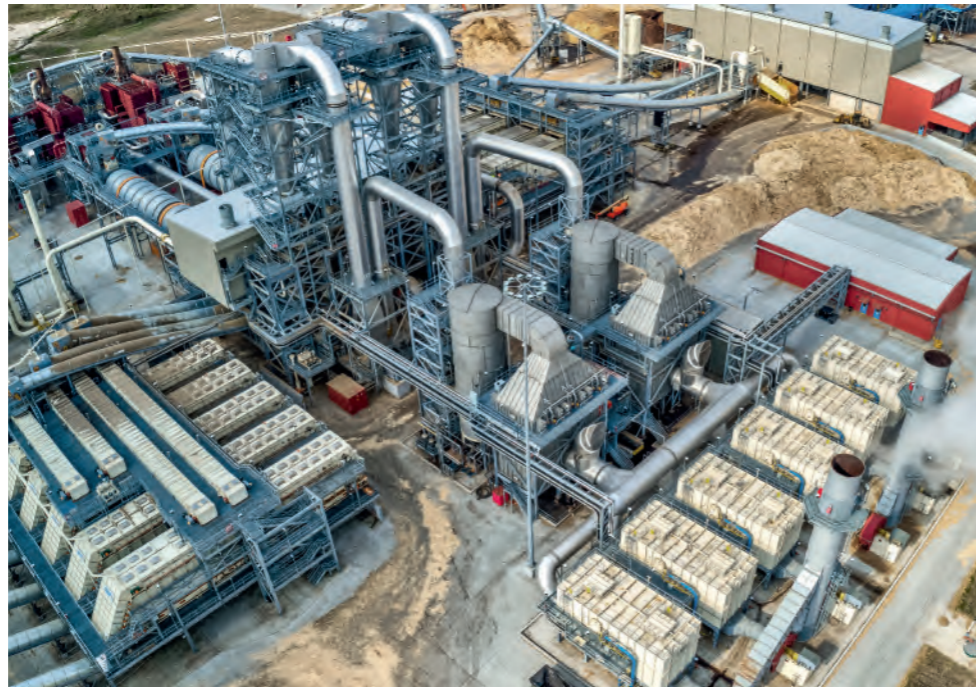
Part.X PV 文丘里洗涤塔、Part.X PW 湿式静电除尘器和 Oxi.X RC RTO 在工程木制品行业中的应用。
